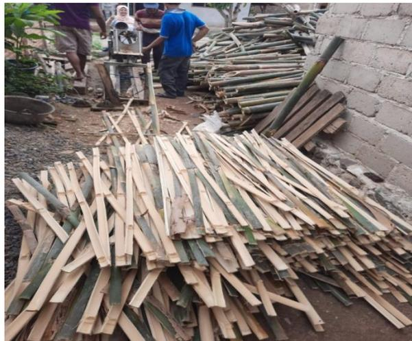
**Gambar 6. Lanjaran bambu hasil pembelahan menggunakan mesin**
