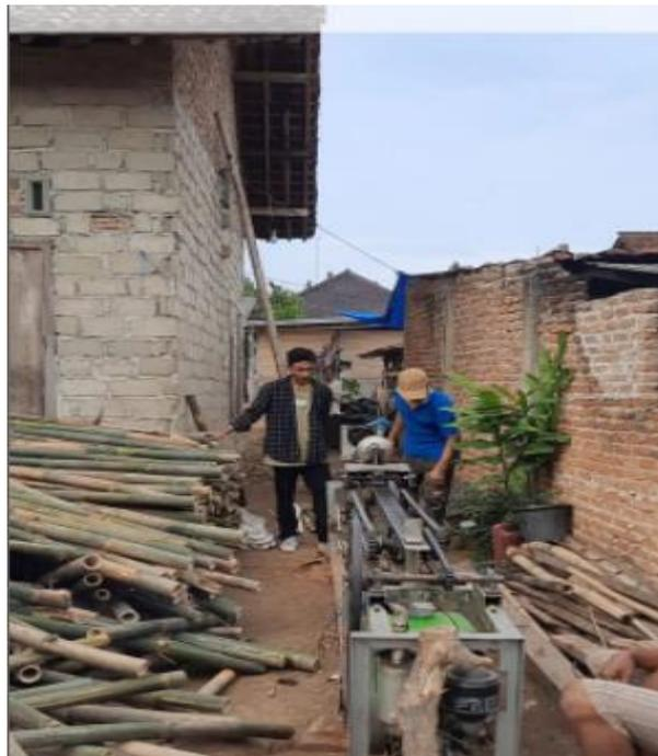
**Gambar 4. Mesin pembelah bambu dan cara mengoperasikan**
