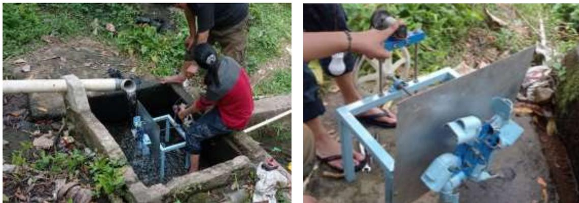
**Gambar 6. Uji coba Turbin di Lapangan**
