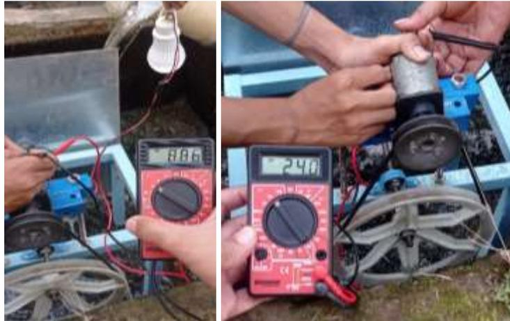
**Gambar 7. Pengukuran Tegangan Generator**
